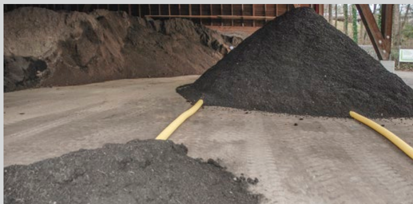
Abb. 14: Belüftung von Komposthaufen mit Drainagerohren bei der Firma Leureka AG. Bild: Jacques G. Fuchs, Biophyt AG. Image 14: Aération de tas de compost avec des tuyaux de drainage chez Leureka AG.
