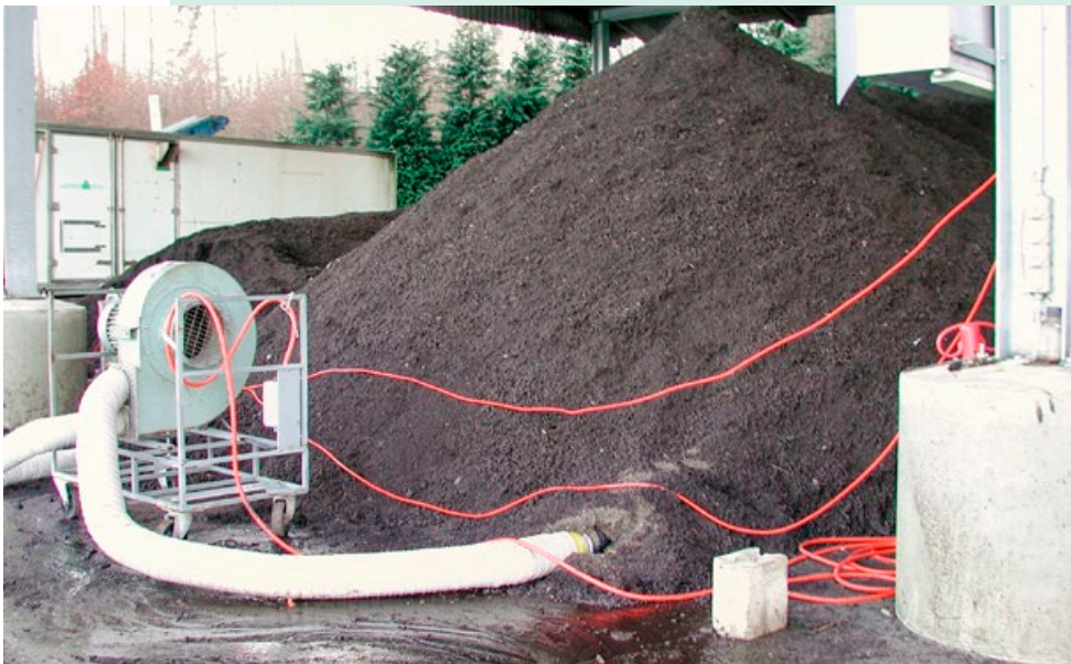
Abb. 9: Kompostbelüftung im Einsatz Bild: Jacques G. Fuchs, Biophyt AG. Image 9: Aération de compost en action.
